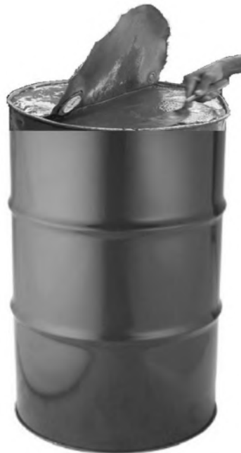
Gambar 1. Contoh enkapsulasi Limbah B3 dengan semen.
