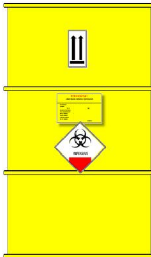
Gambar 7. Contoh pemberian simbol dan label pada wadah atau kemasan drum plastik
